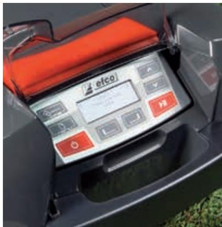
Die Eingabe eines PIN-Codes ist ein wirksamer **Schutz gegen Diebstahl** und Manipulationen durch Unbefugte.
