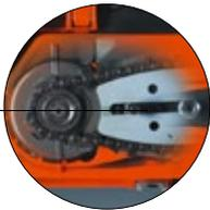
Verwenden Sie immer Husqvarna Kettenöl. Die Verwendung des falschen Öls ist eine häufige Ursache für Ausfälle und zieht nicht selten einen schnellen Verschleiss des Schwertes sowie das Festklemmen oder Lösen der Kette vom Schwert nach sich.
