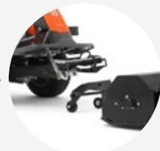
Die Rider der 300er und 400er Serie sind mit einem Befestigungsrahmen ausgestattet, mit dem Sie einfach zwischen Mähwerk und frontmontierten Werkzeugen wie Schlegelmäher, Kehrbürste, Schneefräse und Schneeräumschild wechseln können.
