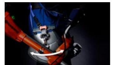
Leicht zugänglicher Auslösemechanismus für den Notfall. Stossdämpfendes, bewegliches Hüftpolster.
