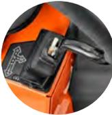
Automatische, in den Steuerhebeln integrierte Feststellbremse
