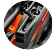
Bequemer, federgestützter Schneidwerkheber
