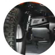
Die schwenkbare, gusseisernerne Frontachse stellt hervorragende Ausgewogenheit und bequemen Fahrkomfort sicher
