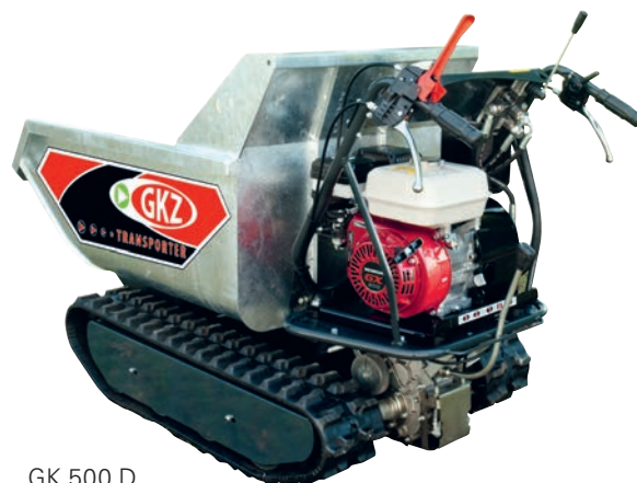
GK 500 D Ausführung mit hydraulischer Kipp-Mulde
