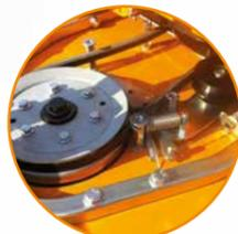
Optimaler Motorschutz durch getrennte Motor- und Messerwelle, Messeruntersetzung 1:1,6
