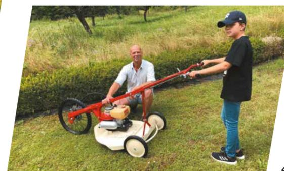
Von einem begeisterten Kunden liebevoll restauriert: ein AS-Motor Allmäher® AS 26 AH 4. Baujahr 1976, mit Vorderradantrieb über biegsame Welle, 92 cm<sup>3</sup>, AS 2-Takt-Motor, 4,7 PS bei 5.200 U/min.
