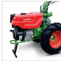
Stützfuß erleichtert den Anbaugerätewechsel und das Abstellen der Maschine ohne Anbaugerät
