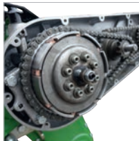
Robustes und langlebiges Kettengetriebe im Ölbad
