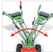
Lenkholm in beide Richtungen seitlich schwenkbar
