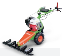
Einfaches Lenken und Manövrieren durch Freischaltung der Räder
