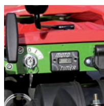
Praktische Armaturtafel inklusive Betriebsstundenzähler, Drehzahlmesser, Zündschloss und 12 V Steckdose
