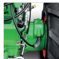
Robuste Lenkbrem- kupplungen für einfaches Lenken
