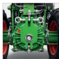
agria-Anbauflansch: einfacher und schneller Anbaugerätewechsel
