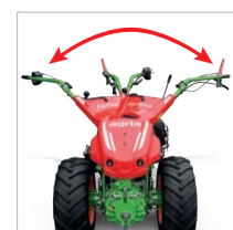
Lenkholm in beide Richtungen seitlich schwenkbar
