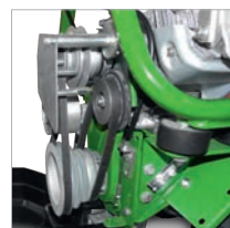
Wahl der passenden Arbeitsgeschwindigkeit durch einfaches Umlegen des Antriebsriemens
