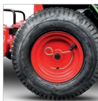
Besonders wendig durch Radfreilauf
