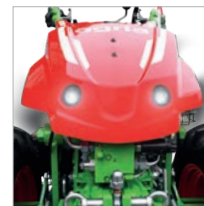
Gute Sichtbarkeit durch LED-Sicherheitsleuchten
