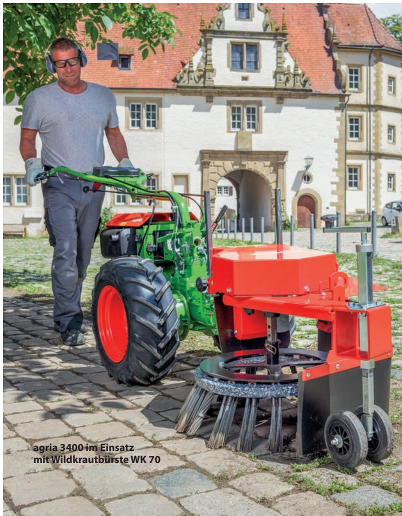
Stützfuß erleichtert den Anbaugerätewechsel und das Abstellen der Maschine ohne Anbaugerät
