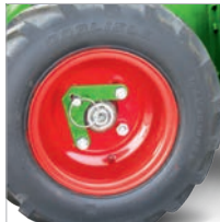
Radmitnehmer: wahlweise Einzelrad- oder Zweiradantrieb
