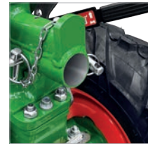
Zusätzliche Aufnahme für gezogene Geräte, z. B. Pflüge
