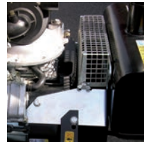
Optimierte Luftansaugung schützt den Motor vor Überhitzung
