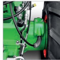
Robuste Lenkbremskupplungen für einfaches Lenken
