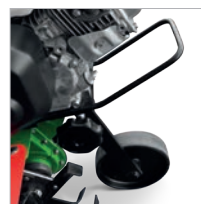
Frontlaufrad und Haltegriff für einfachen Transport
