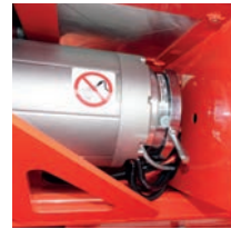
Sicherheit am Hang dank elektromechanischer Bremse
