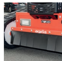
Schutz vor Steinschlag: Wurfkörperprüfung nach DLG
