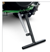
Stützfuß erleichtert das Abstellen der Maschine
