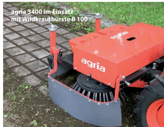
Stützfuß erleichtert den Anbaugerätewechsel und das Abstellen der Maschine ohne Anbaugerät
