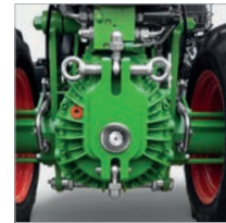
agria-Anbauflansch: einfacher und schneller Anbaugerätewechsel
