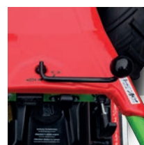
Sicheres Abstellen der Maschine mit zentraler Feststellbremse
