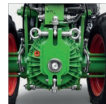
agria-Anbauflansch: einfacher und schneller Anbaugerätewechsel
