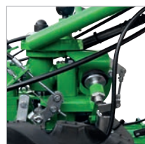
Patentiertes Anti- vibrations-Zweiachs- Holmlagerung
