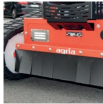
Schutz vor Steinschlag: Wurfkörperprüfung nach DLG
