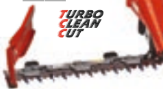
Normal-Fingerbalken mit 6mm Federstahl-Messerrücken und 2mm starke Klingen Geschmiedete Finger mit 76,2mm Abstand und beidseitigem Schnitzzusatz Schwadböle mit Schleifsohlen DIN 80 konform
