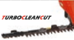
Mittelschnitt-Freischnittbalken mit 6mm Federstahl-Messerrücken und 2mm starke Klingen Geschmiedete Finger mit 50,6mm Abstand und beidseitigem Schnitzzusatz Außen mit Schleifsohlen DIN 80 konform
