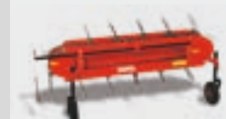
Zum Wenden und Schwaden Zwei Keilriemenantriebe mit mittlerer und oberer Keilriemenführung Fixierbare Vorderräder 185 zwei Zinken pro Zinkenreihe 230 drei Zinken pro Zinkenreihe Bandantrieb auf gegenüberliegender Seite (bergseitig) des Auswurfs (talseitig) → ideale Hang-Gewichtsverteilung
