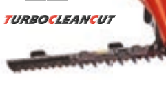
Normal-Freischnittbalken mit 6mm Federstahl-Messerrücken und 2mm starke Klingen Geschmiedete Finger mit 76,2mm Abstand und beidseitigem Schnitzzusatz Außen mit Schleifsohlen DIN 80 konform
