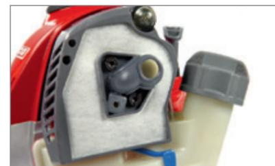
Das Filtergehäuse mit Anti-Kraftstoff-Ableitungsdiele (Emak-Patent): verhindert, dass sich der Filter mit dem Treibstoffgemisch vollsaugt und gewährleistet eine längere Betriebszeit zwischen den Wartungsarbeiten.
