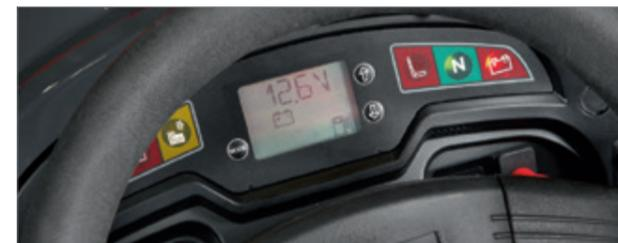
Elektronisches LCD-Display, das eine schnelle und unmittelbare Anzeige der wichtigsten Informationen des Gartentraktors ermöglicht, einschliesslich Betriebsstunden, Batteriespannung und Kraftstoffstand.
