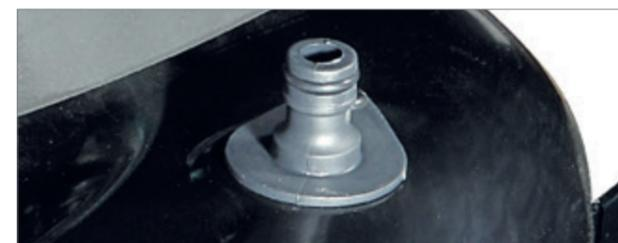
Der Schnellanschluss «Deck-Wash-System» am Mähdeck ermöglicht es Wasser in das Mähdeck zu leiten, um das Schneidwerk schnell und einfach zu reinigen.
