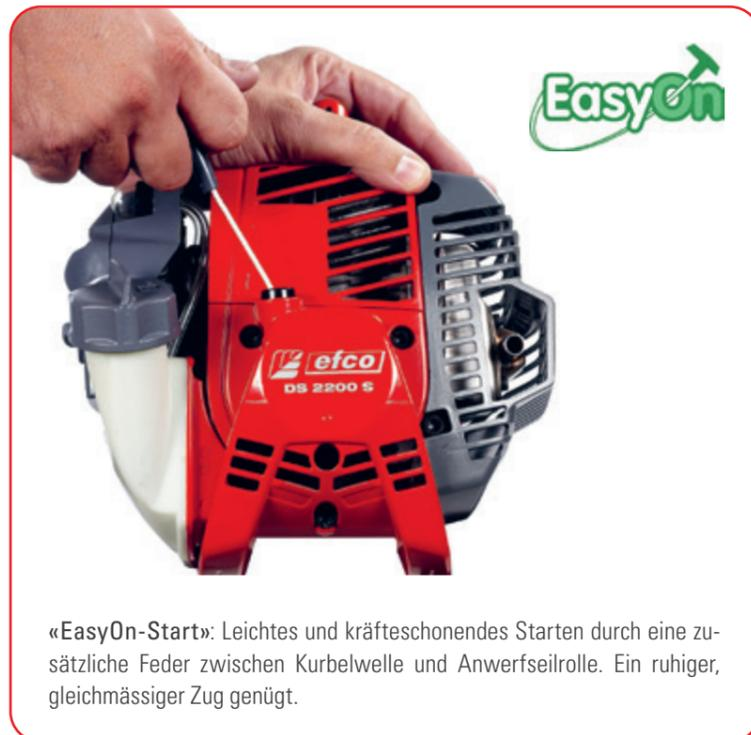
«EasyOn-Start»: Leichtes und kräfteschonendes Starten durch eine zusätzliche Feder zwischen Kurbelwelle und Anwerfseilrolle. Ein ruhiger, gleichmässiger Zug genügt.
