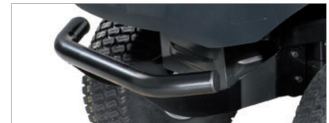
Grosszügig dimensionierte Frontstossstange aus Stahl für hohe Festigkeit und Widerstand bei einem ungewollten Aufprall.
