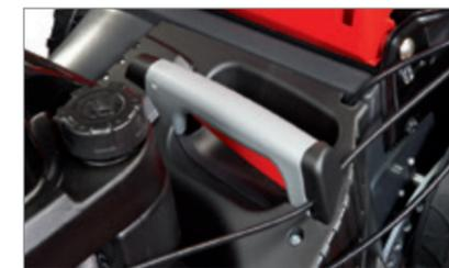
Schnitthöhenverstellungssystem, das über einen praktischen Hebel bedient wird.
